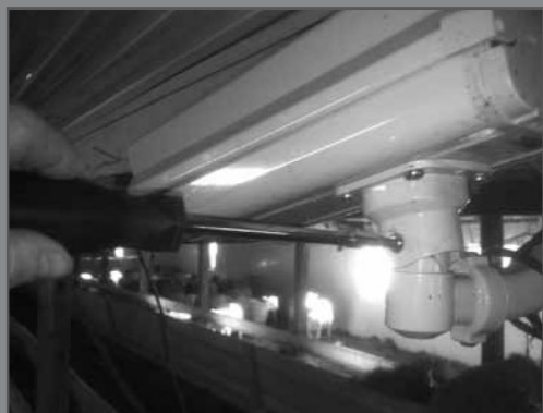
Ajustement de l'angle de prise de vue : ce boîtier offre une très grande flexibilité à ce niveau.
