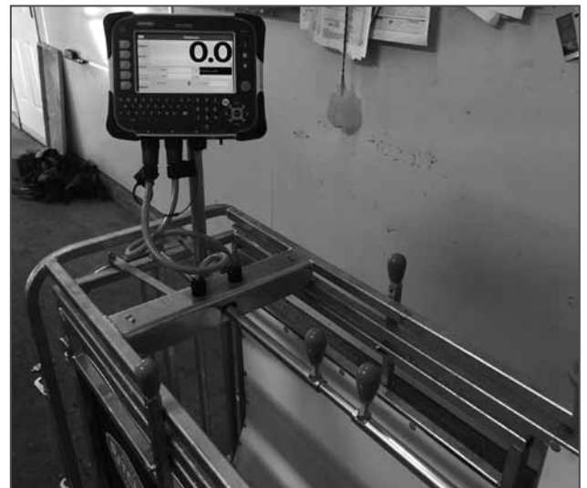
Le poste de commande avec toutes les manettes pour les ouvertures et fermetures de portes
