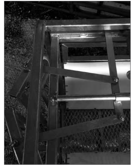
Mécanisme de blocage des portes avant et arrière en position ouvert
