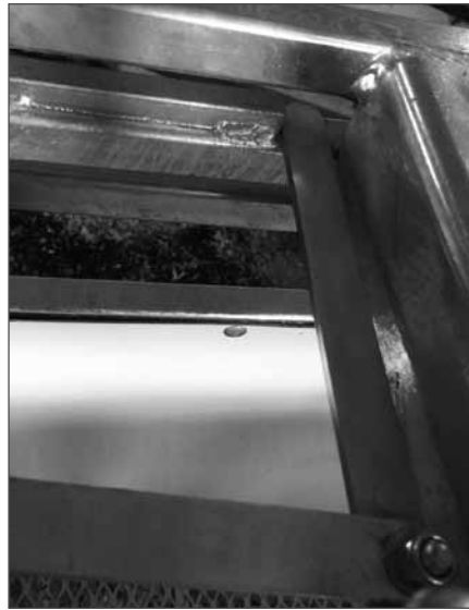
Mécanisme de blocage des portes avant et arrière en position fermé
