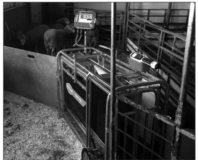
L'installation complète avec l'indicateur de pesée et le bâton de lecture RFID
