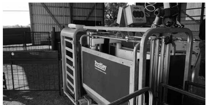
Trieur Prattley : balance trieuse Prattley, tirage à trois sorties contrôlées par l'indicateur de pesée. Les agneaux avaient plus de difficultés à entrer dans cet appareil. Le bruit des vérins pneumatiques ajoutait un élément de stress.
