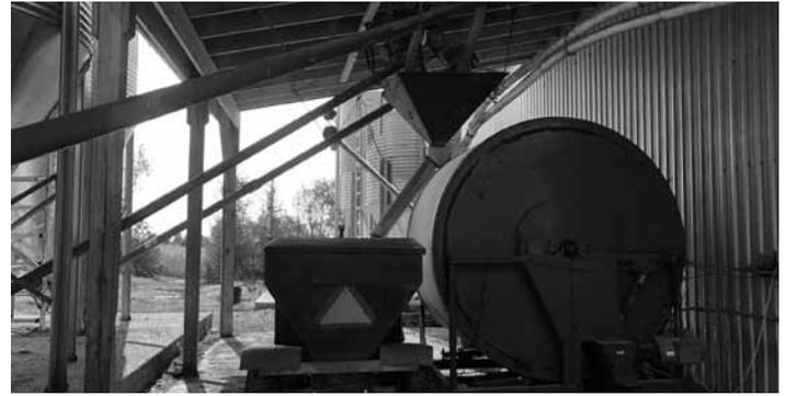
Mélangeur parc engraissement : le mélangeur à tambour pour le mélange des rations de grains du parc d'engraissement.
