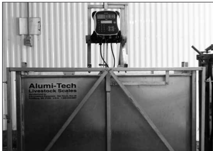
Indicateur EziWeigh7 installé sur une cage de pesée.
