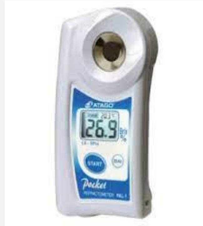
Avant usage, déposer quelques gouttes d'eau distillée sur œil optique. La valeur exprimée sera zéro.
